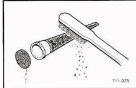
4. Verificar o filtro do silenciador e o para-chispas, e substituir em caso de danos.
